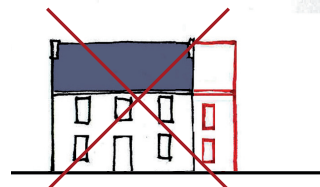
Extension faussant la symétrie de la façade en recréant une 4ème travée
